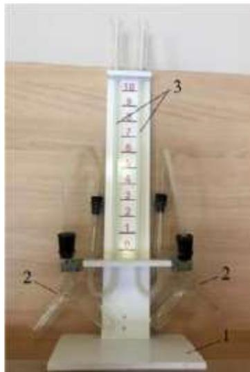
Прибор состоит из подставки, на которой закреплены две манометрические трубки, которые соединяются с сосудами Ландольта с помощью пластиковой трубки с пробками (рис. 5) . Между манометрическими трубками на панели нанесена шкала для наблюдения уровня жидкости в трубках . Окрашенной жидкостью может быть раствор любого красителя в воде .
