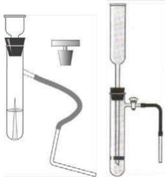
**Рис. 7.** Прибор для получения и собирания газов
